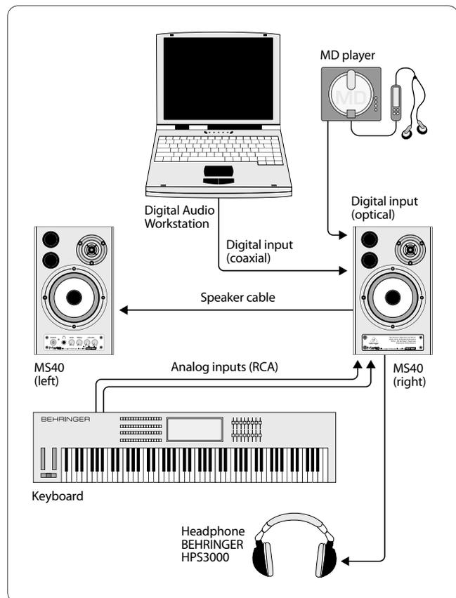
Рис. 3.1: Пример использования с компьютером и синтезатором
